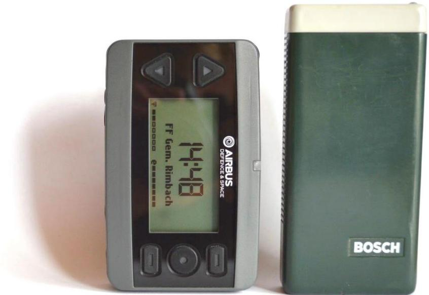
Größenvergleich: Airbus P8GR vs. Bosch FME
